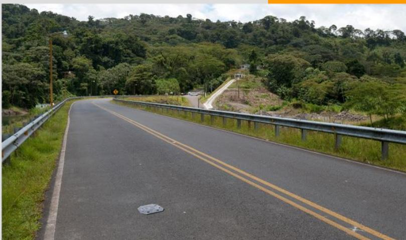
L'analizzatore di traffico portatile NC350 BlueStar con Tecnologia Bluetooth™ fornisce misurazioni accurate di conteggio, velocità e lunghezza dei veicoli. Il sensore di traffico portatile NC350 BlueStar è posto direttamente sulla corsia di traffico per misurare i dati, può essere installato e rimosso rapidamente e facilmente senza danneggiare il manto stradale.
